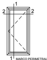
ACRISTALAMIENTO DESDE 4mm HASTA 36mm DE ESPESOR. DISEÑO DE 4 CÁMARAS DE AISLACIÓN EN MARCO.
